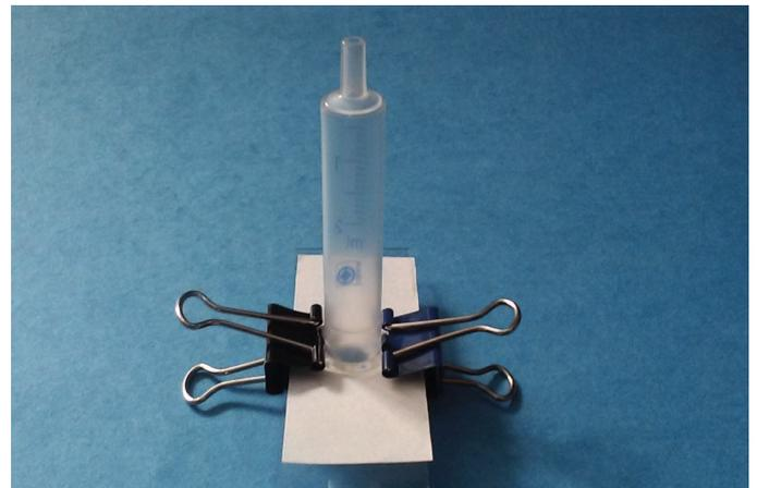
Fig. 2: Cámara de sedimentación casera construida con un portaobjetos, un papel de filtro perforado, una jeringa y dos pinzas de presión fuertes.
